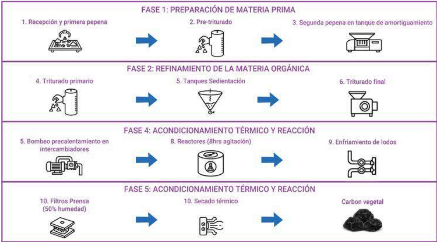
Diagrama de proceso de la Planta de carbonización hidrotermal
