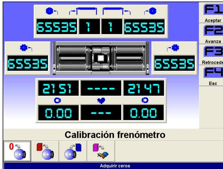
Figura 5.85 - Calibración del Frenómetro.
