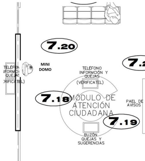
**Figura 6.6** Ejemplo de posición de cámaras en Módulos de Información.
