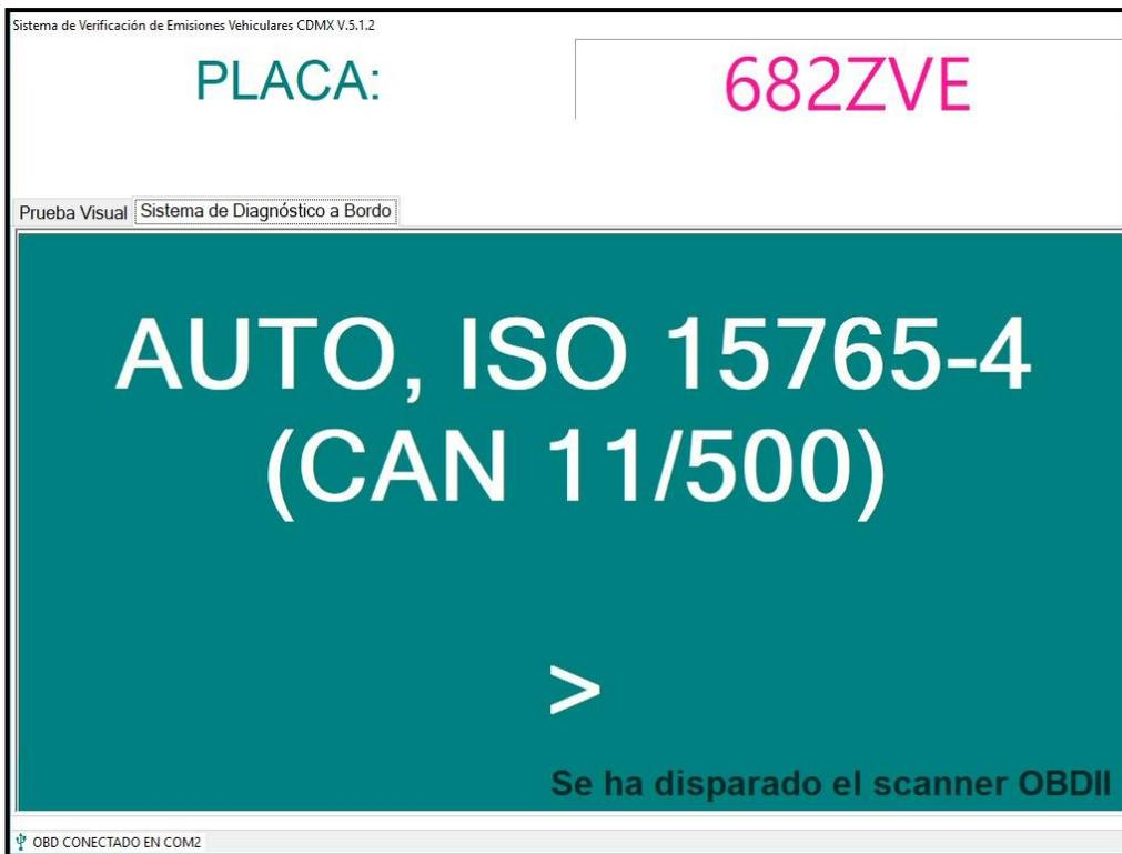
**Figura 5.46** Pantalla de protocolo OBDII encontrado en el vehículo.
