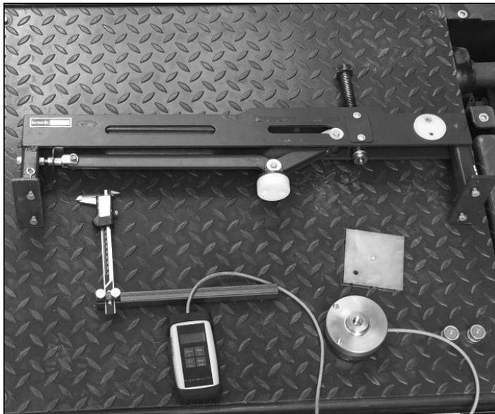
**Figura 5.79.** Equipo de calibración para banco de suspensiones el cual consta de: brazo, soportes magnéticos de calibrador, calibrador, celda de carga y base.
