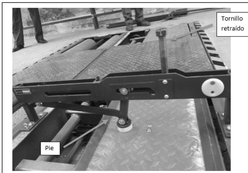
**Figura 5.80** Arreglo para la calibración de la constante de amortiguamiento.
