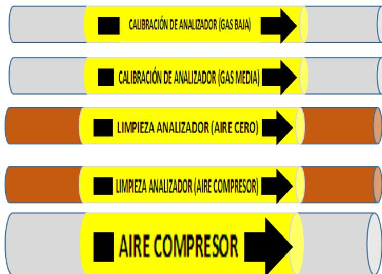
**Figura 4.10** Ejemplo de etiquetas de identificación de tuberías de gases de calibración.
