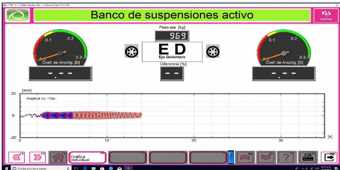
Figura 5.29 Pantalla de medición para la suspensión del eje delantero de la línea de inspección F-M.
