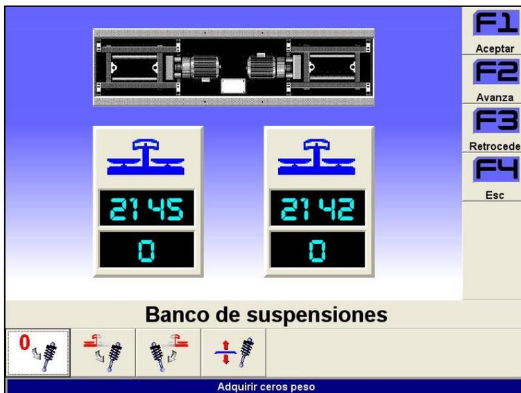
**Figura 5.81** Calibración del banco de suspensiones Eusama.
