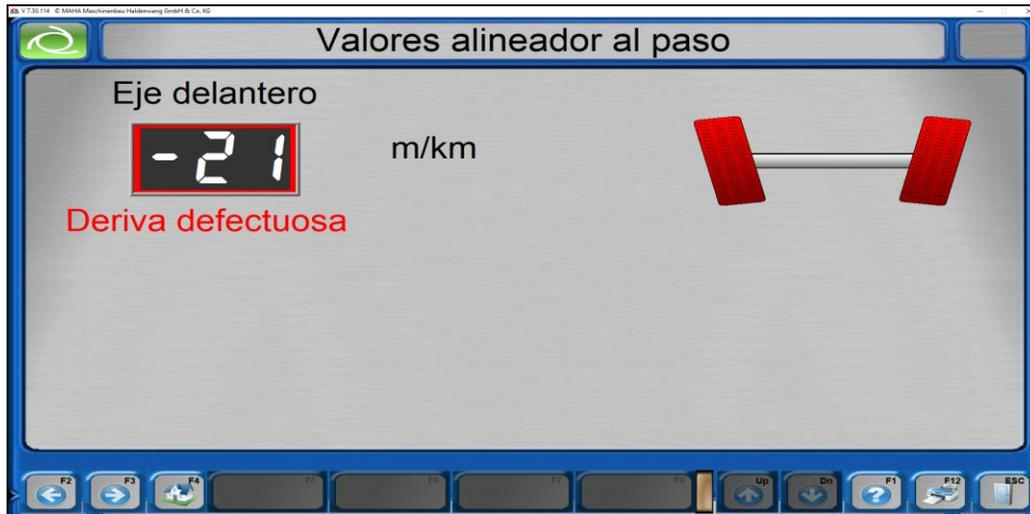
Figura 5.28 Pantalla de medición para la deriva del eje delantero de la línea de inspección F-M.
