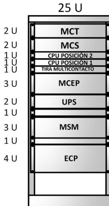
**Figura 4.1** Ejemplo del rack y ubicación de los módulos en el GPE.
