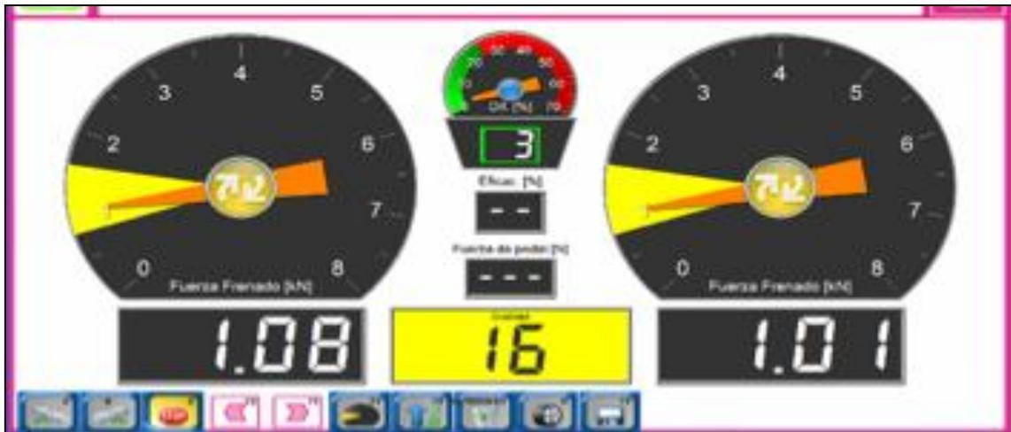
Figura 5.30 Pantalla de medición para el frenómetro de rodillos en el eje delantero de la línea de inspección F-M.
